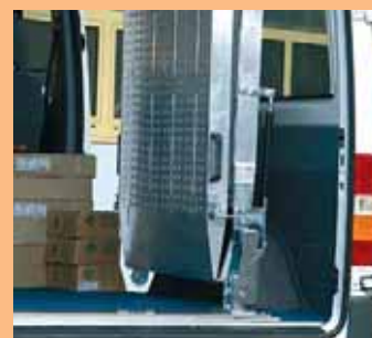
Рампа вращается как на улице, так и внутри автомобиля.
