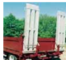
Пружинный подъемный механизм для въездных рамп Стр. 22/23
