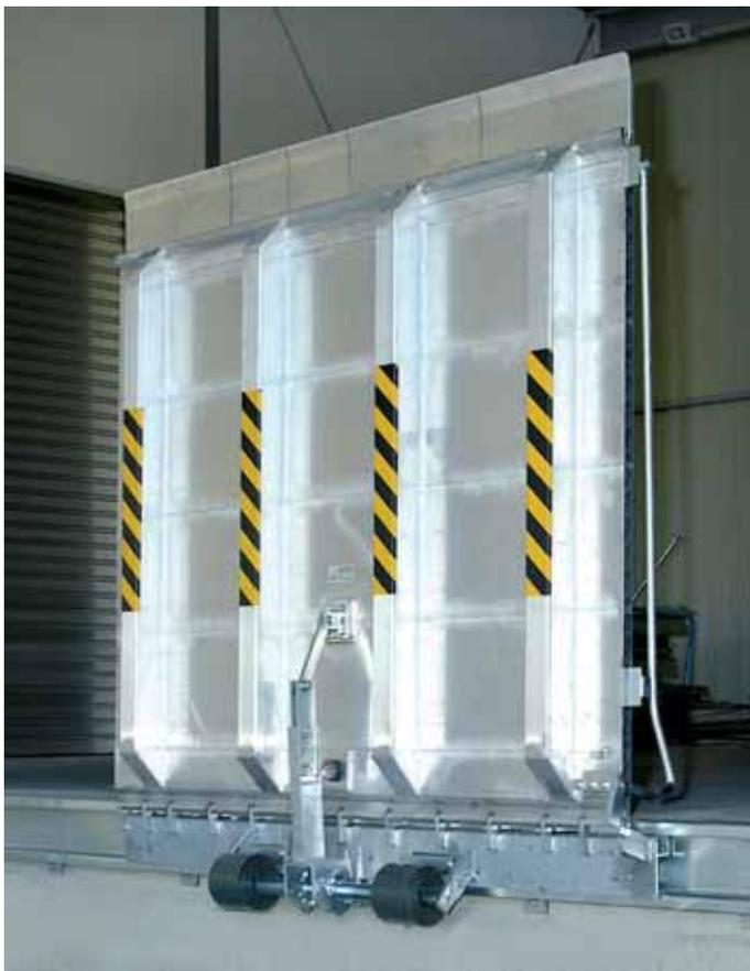
Подъемная поддержка может оптимально устанавливаться на платформах любых размеров благодаря применению надежных пружин. Это достигается варьированием количества пружин и их ширины.
