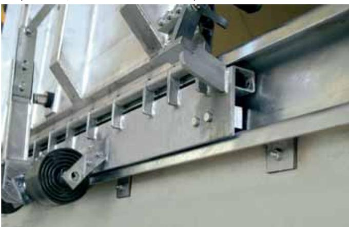
Оцинкованный лист стали на верхней стороне рамы, закрепленный болтами.
