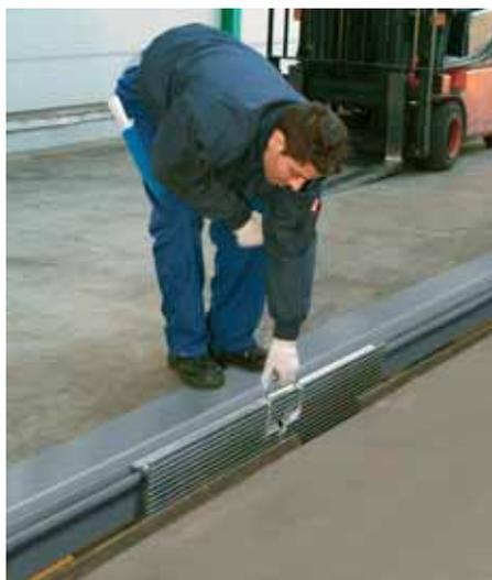
Край моста положить на рабочую поверхность, вставив соединительный элемент в шину.
